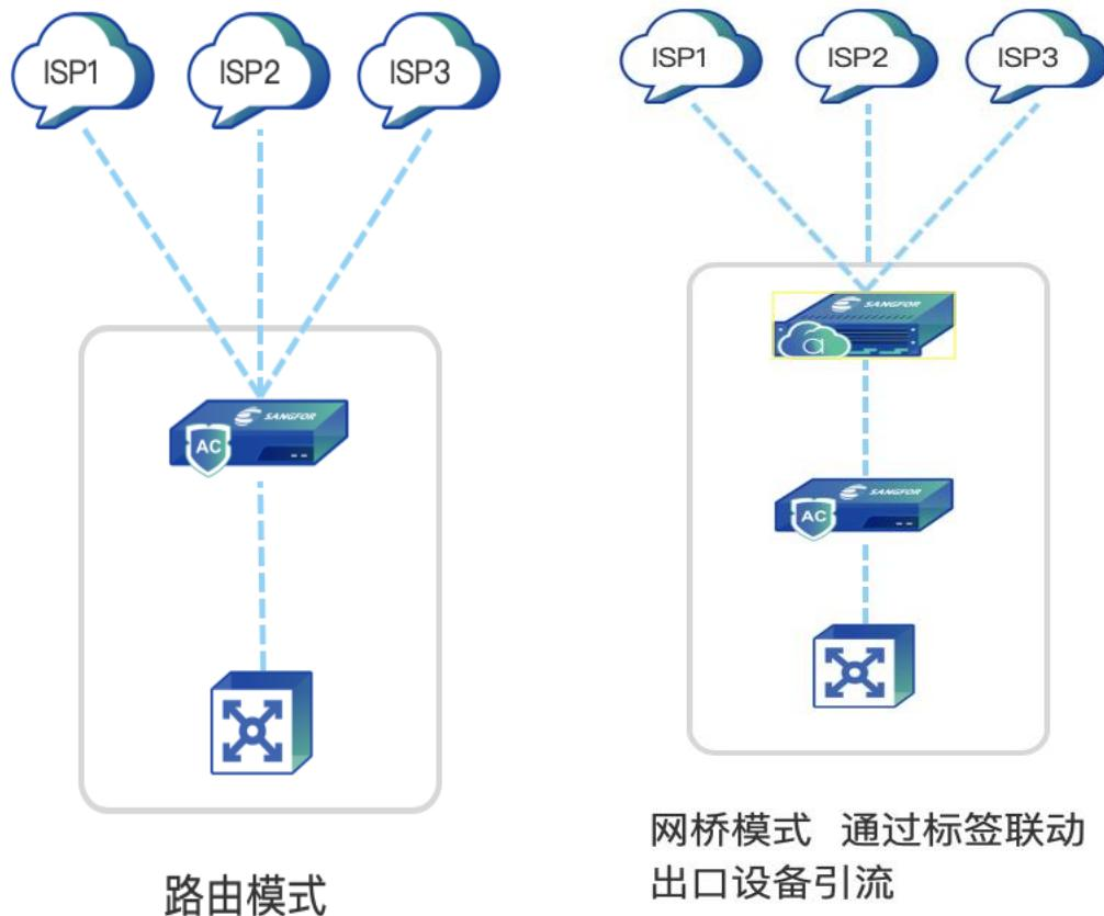
Sangfor IAM menggunakan teknologi seperti routing technology , DNS transparent proxy technology, dan link busy control untuk implementasi link allocation berbasis pada load condition, time periods, user groups, access objects, dan faktor lain untuk meningkatkan optimisasi link. rate.
