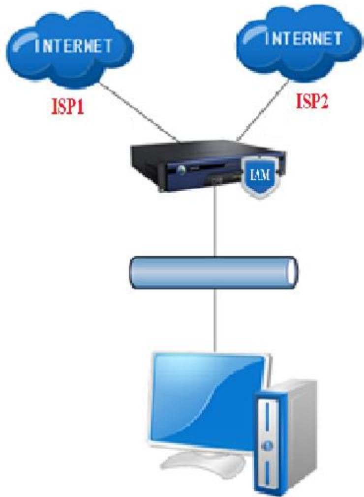
Solusi: Konfigurasi Policy-Based Routing, source address dari internal network, menentukan destination address yang ditentukan, dan pilih yang sesuai line.
