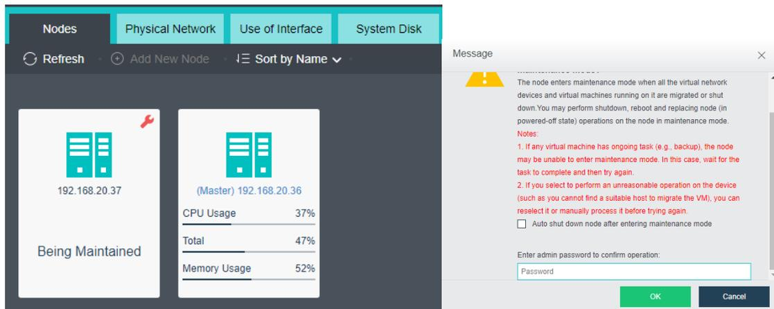
3. Setelah host memasuki mode pemeliharaan, mulailah untuk mengganti system disk.
